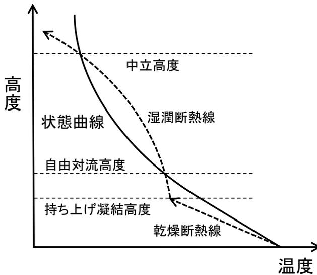
本実験では、**ショワルター安定指数**（SSI）を用いて、大気安定度を評価する。ショワルター安定指数とは、500 hPaにおける実際の気温と、850 hPaの位置にある空気塊を断熱的に500 hPaまで持ち上げたときの空気塊の温度との差として定義される。持ち上げた空気塊の温度のほうが高ければショワルター安定指数は負の値となる。このような場合には、持ち上げた空気塊の温度がまわりの空気の温度よりも高いため、浮力によってさらに上昇することになり、大気の状態が不安定であるといえる。理論的には、0℃未満であれば不安定、0℃より大きければ安定ということになるが、日射による地表付近の昇温などを見込み、+2℃以下の場合には雷発生に注意が必要であるとされている。
