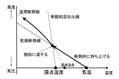
エマグラム上に、実際に観測された気圧(高度)と気温、露点温度との関係をプロットすれば、 大気の安定度を解析することができる。持ち上げた空気塊の温度が、その高度における気温より 高い場合には、さらに浮力を受けて上昇しようとするので、大気の状態は不安定である。
