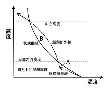
本実験では、ショワルター安定指数(Showalter stability index; SSI)を用いて、大気の安定度を 評価する。ショワルター安定指数とは、500hPaにおける実際の気温と、850hPaの位 置にある空気塊を断熱的に500hPaまで持ち上げたときの空気塊の温度との差として定義さ れる。持ち上げた空気塊の温度のほうが高ければショワルター安定指数は負の値となる。このよ うな場合には、持ち上げた空気塊の温度がまわりの空気の温度よりも高いため、浮力によってさ らに上昇することになり、大気の状態が不安定であるといえる。理論的には、0℃未満であれば 不安定、0℃より大きければ安定ということになるが、日射による地表付近の昇温などを見込み、 +2℃以下の場合には雷発生に注意が必要であるとされている。
