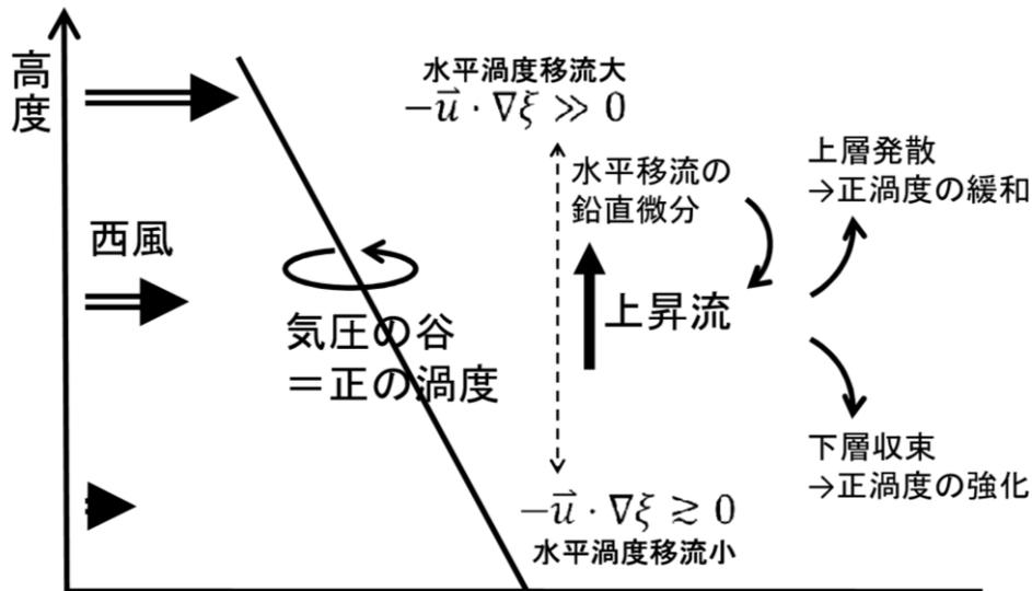
一方、第2項  $F_2$  は温位偏差の水平移流の水平2階微分である。たとえば、トラフの前面では南風によって正の温度移流が生じているから、温度移流項は正である。これを水平2階微分し、符号を反転されたものが  $F_2$  であるから、結局  $F_2$  は正である。したがって、トラフの前面では温度移流によって上昇流を生じさせる作用がはたらくことがわかる。上昇流によって温度が低下するので、水平温度移流によって生じる温度偏差は緩和される。
